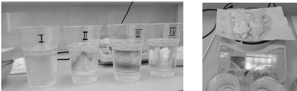
Рис. 2. Определение водопоглощения образцов сорбента
