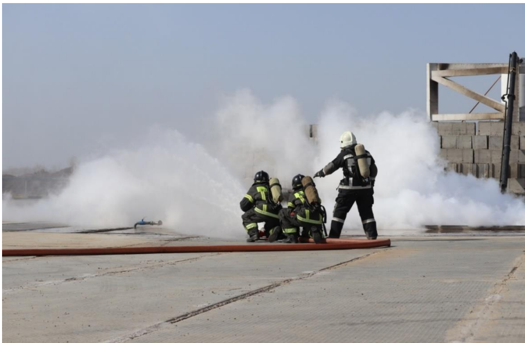
Рис. 3. Регазификация газового облака при помощи водяных струй лафетных стволов
