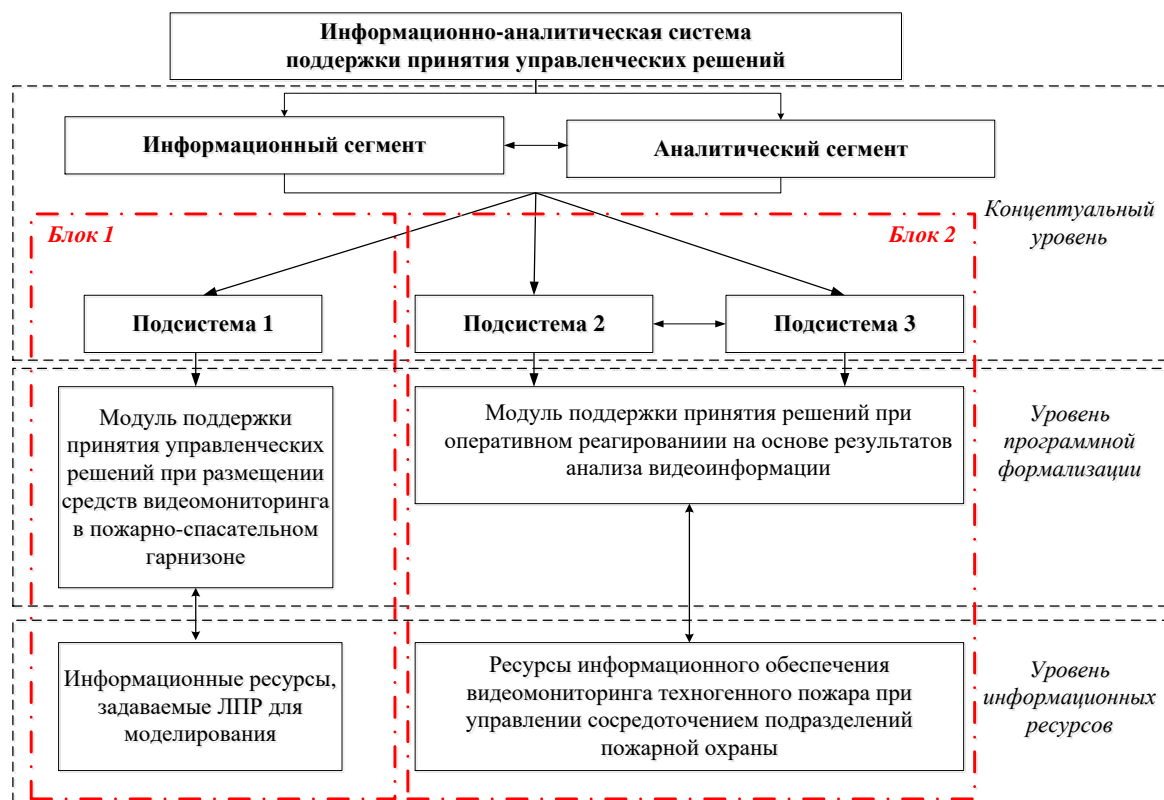
Рис.1. Уровневая структура информационно-аналитической СППР, формализованной в ПК
