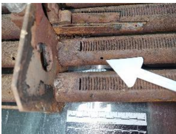
Рис. 2. Отверстие Ø 4 мм на второй горелке за панелью (т.е. в топке котла)
