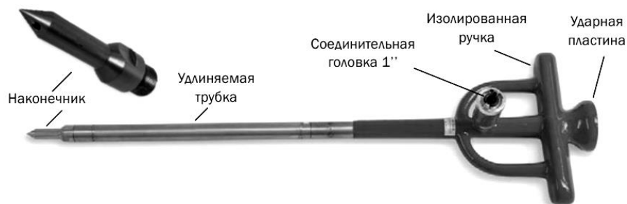
Рис. 3. Пожарный ствол «копьё» для тушения электромобилей
