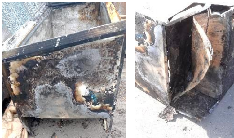
Рис. 4. Внешнее состояние морозильного ларя с компрессорным отсеком
