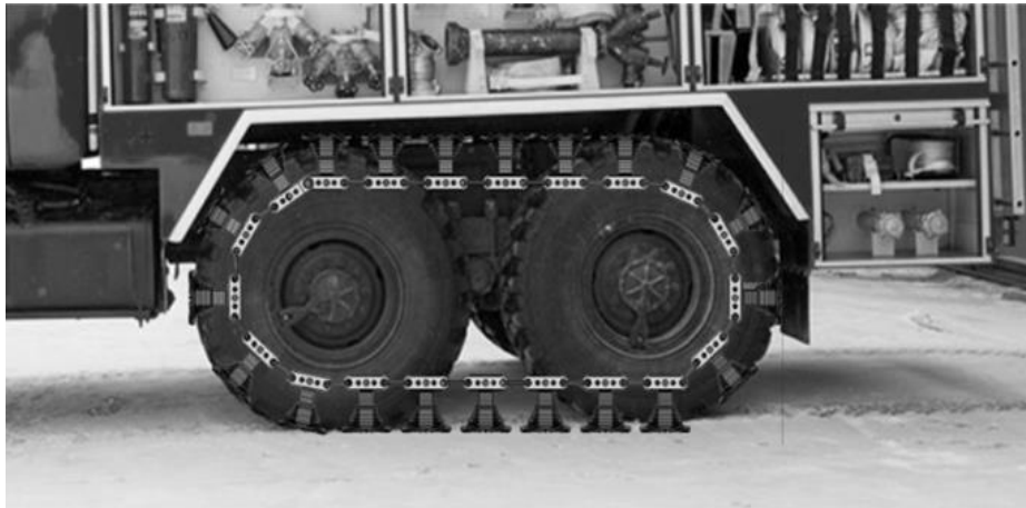
Рис.1. Резиновые гусеницы, установленные на колеса пожарного автомобиля
