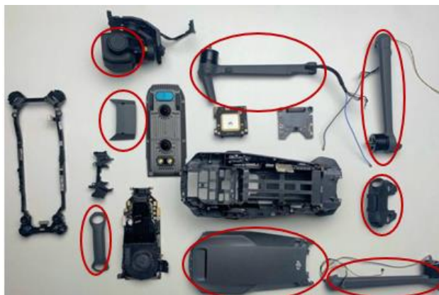
Рис.2. Детали беспилотного летательного аппарата, которые можно заменить продуктом 3D печати
