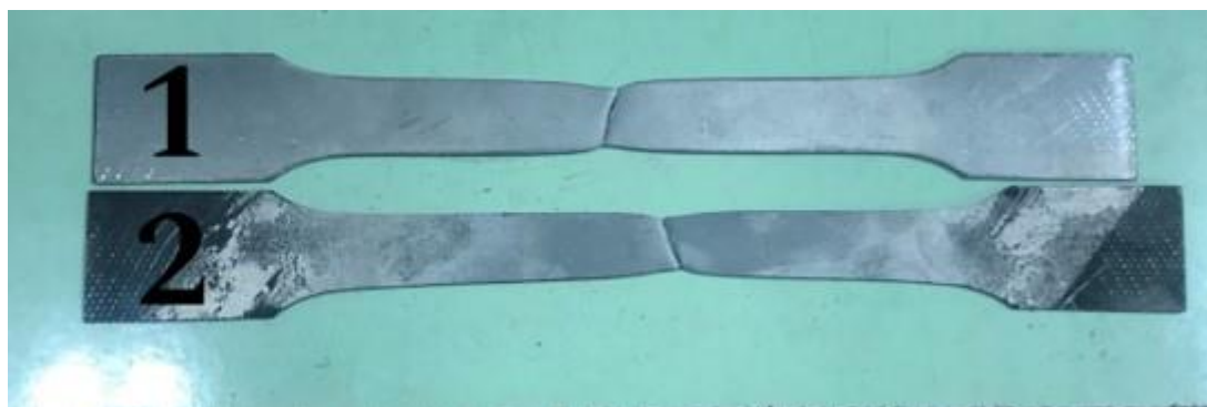
Рис. 4. Экспериментальные образцы после разрушения: 1 – без нагрева, 2 – нагрев до 800 °С
