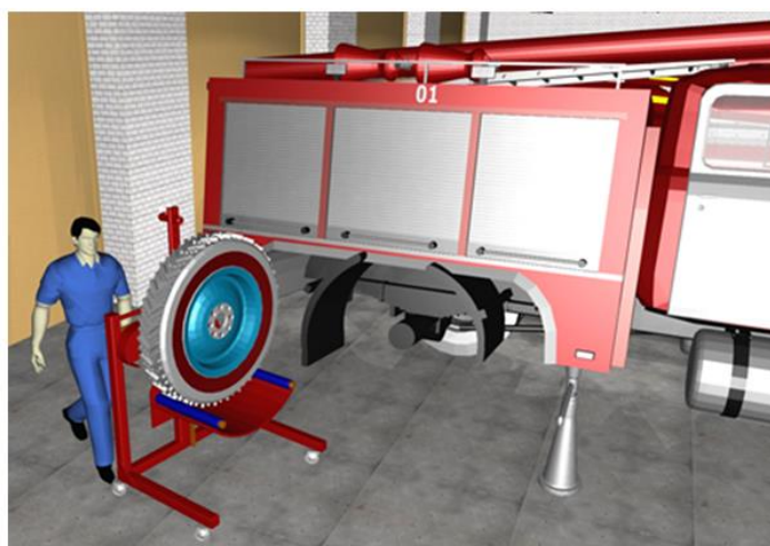
Рис. 3. Использование подкатной тележки для транспортировки и монтажа колес пожарной техники в условиях пожарно-спасательной части
