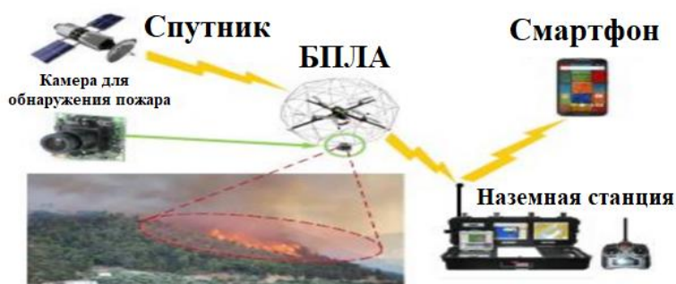
Рис. 1. Общий обзор мониторинга лесных пожаров с помощью БПЛА
