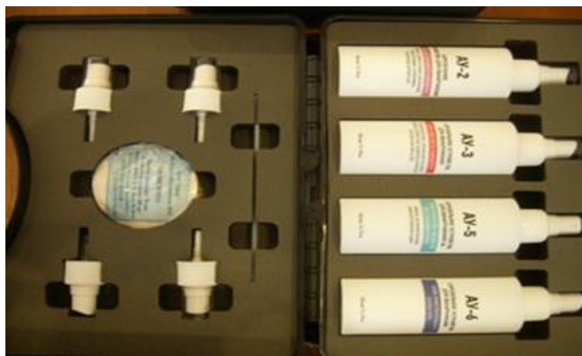
Рис. 2. Внешний вид типового кейса (модуль № 1) с индикаторными рецептурами на агрессивные химические вещества в раскрытом положении
