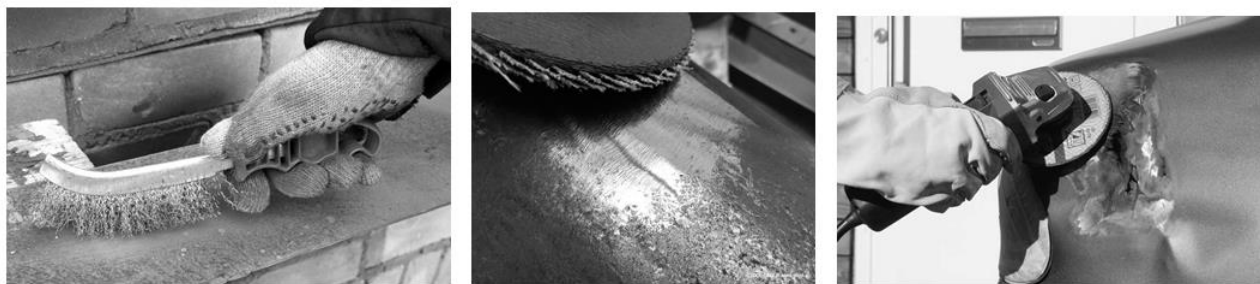
Рис.2. Механическая обработка металла от коррозии
