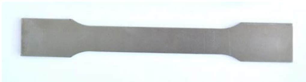
Рис. 2. Образцы конструкционной стали до испытания
