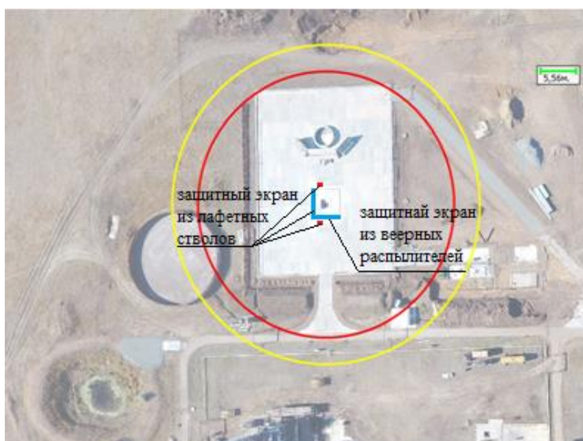
Рис. 1. Схема расположения веерных распылителей и лафетных стволов
