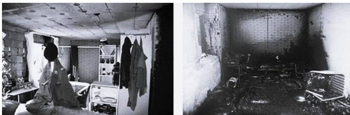
Рис. 2. Экспериментальная квартира до и после пожара [5].
