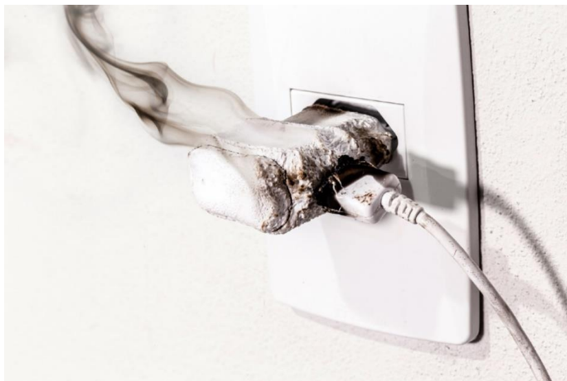
Рис. 2. Оплавленное зарядное устройство
