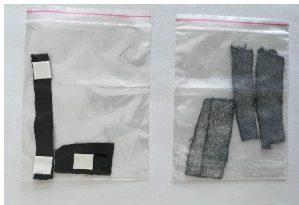
Рис. 3. Простейшее средство индикации углекислого газа до и после воздействия углекислого газа
