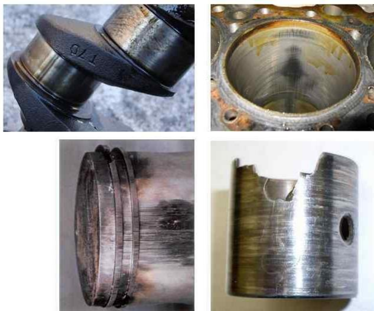
Рис. 1. Износ деталей кривошипно-шатунного механизма двигателя
