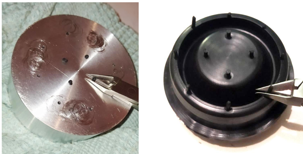
Рис. 5. Отрезание выступающих элементов со сборочной единицы
