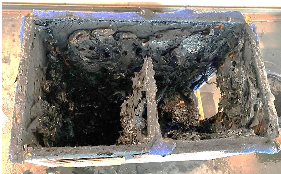
Рисунок. Экспериментальная модель со следами термических поражений
