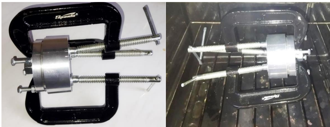
Рис. 4 а, б. Окончательное поджатие разогретой пресс-формы
