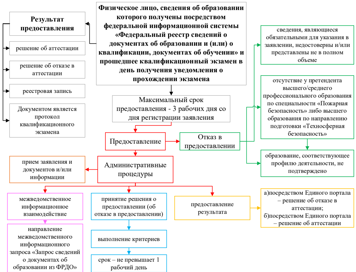
Рис. 3. Блок-схема аттестации физического лица при его обращении через СИС с прохождением экзамена в день получения уведомления
