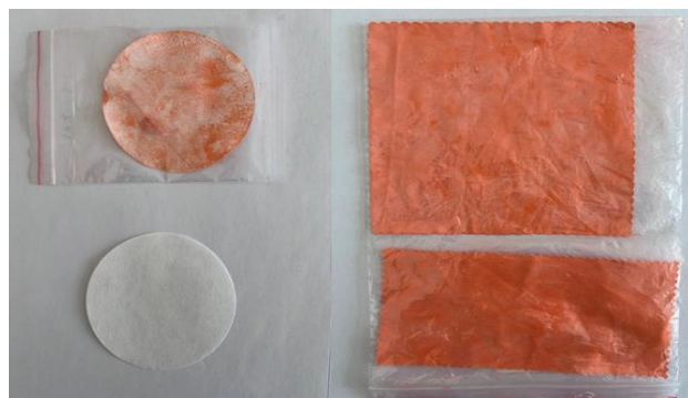
Рис. 5. Простейшие индикационные средства косвенного контроля содержания углекислого газа и фиксации температурных изменений атмосферы КС и температуры тела космонавтов
