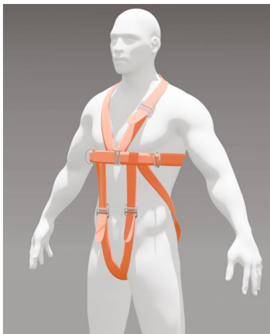
Рис. 4. Изображение 3D модели многофункционального устройства для страховки и работы на высоте (вид спереди)
