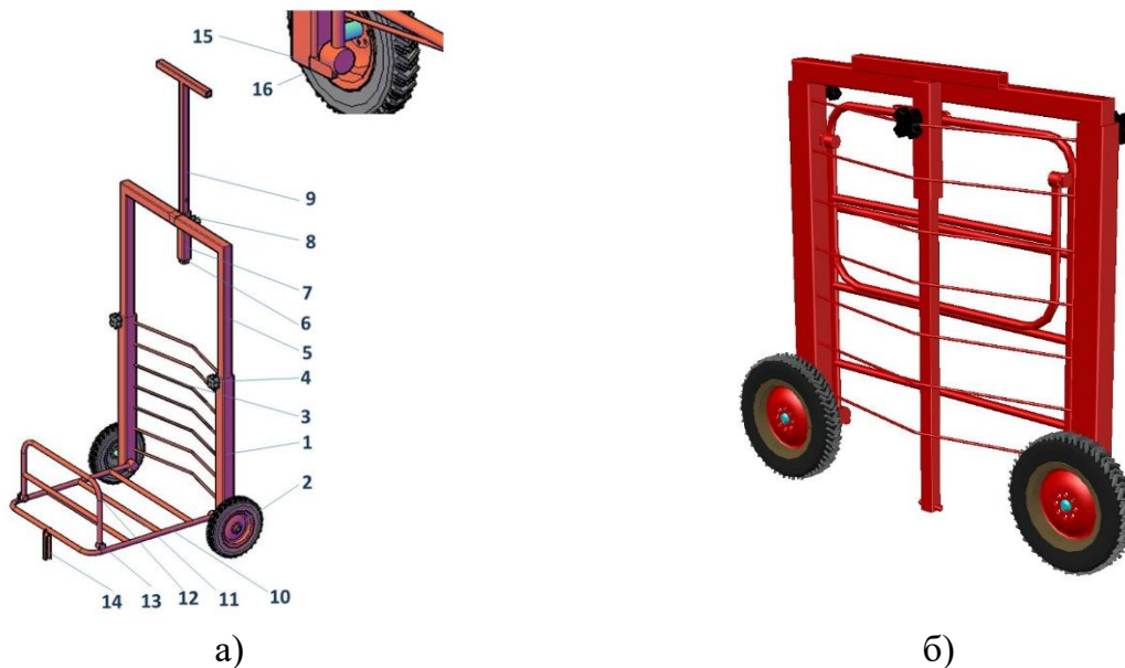
Рис. 1. Универсальная складная мобильная тележка для транспортировки ПТО: а - тележка в развернутом положении; б – тележка в транспортировочном положении; 1 - рама тележки; 2- колесо; 3 – поперечные перекладины рамы; 4 – фиксатор винт «барашек»; 5 – выдвижная рама; 6 – ограничитель выдвижения рукояти; 7 – втулка выдвижной рукояти; 8 – фиксатор винт «барашек»; 9 – выдвижная рукоять; 10 – грузовая площадка; 11 – поперечные перекладины грузовой площадки; 12 – откидной упор; 13 – шарнир откидного упора; 14 – откидная «ножка»; 15 – фиксатор грузовой площадки; 16 – втулка грузовой площадки
