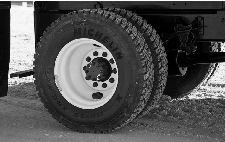
Рис. 4 Задний мост со сдвоенной парой колес шасси «КамАЗ-43253»
