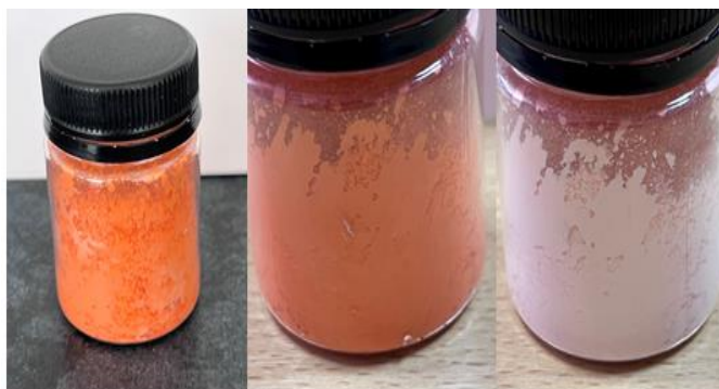
Рис. 4. Переход окраски пигмента от оранжевого до бледно-розового при изменении температуры от 30°C до 68°C
