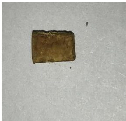
Рис. 5 Образец стали марки Ст3сп после пребывания в дистиллированной воде
