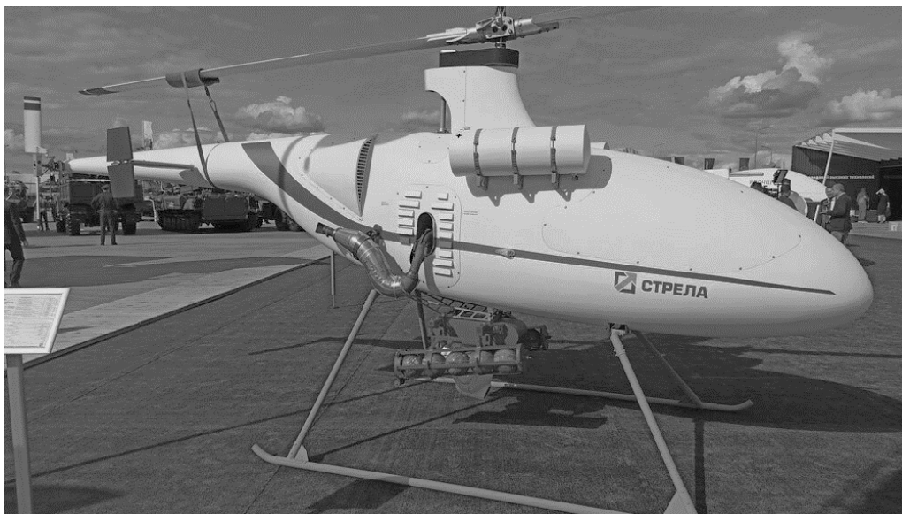
Рисунок. БПЛА для тушения пожара «Стрела» (BVC-VT 450)
