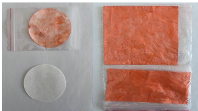
Рис. 2. Простейшие индикационные средства контроля температуры воздуха окружающей среды
