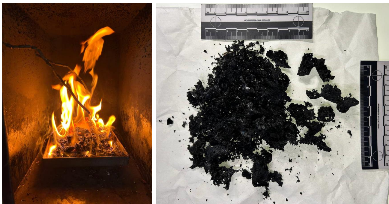
Рис. 4. Процесс горения и зольный остаток образца № 1
