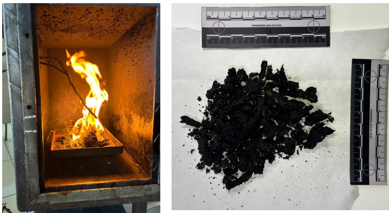
Рис. 5. Процесс горения и зольный остаток образца № 2
