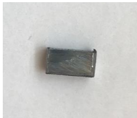
Рис. 6. Образец стали марки Ст3сп после пребывания в водном растворе Рофамина Т (0,1 мг/мл)
